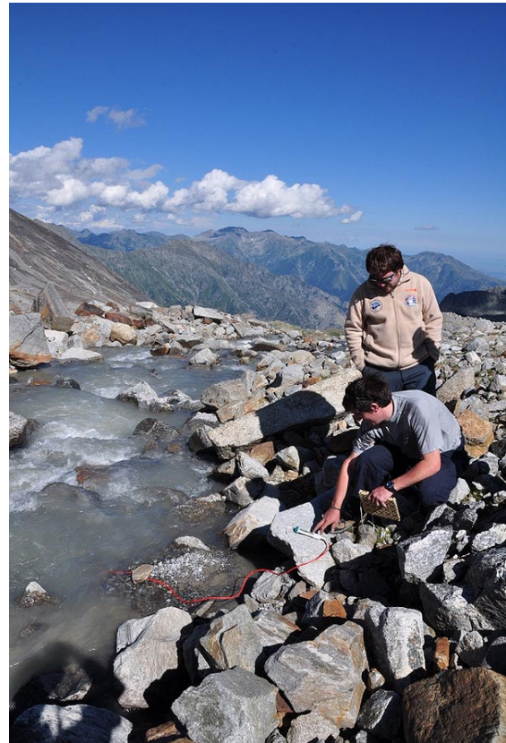
Misure di conducibilità elettrica delle acque del torrente glaciale per la taratura delle misure di portata.
