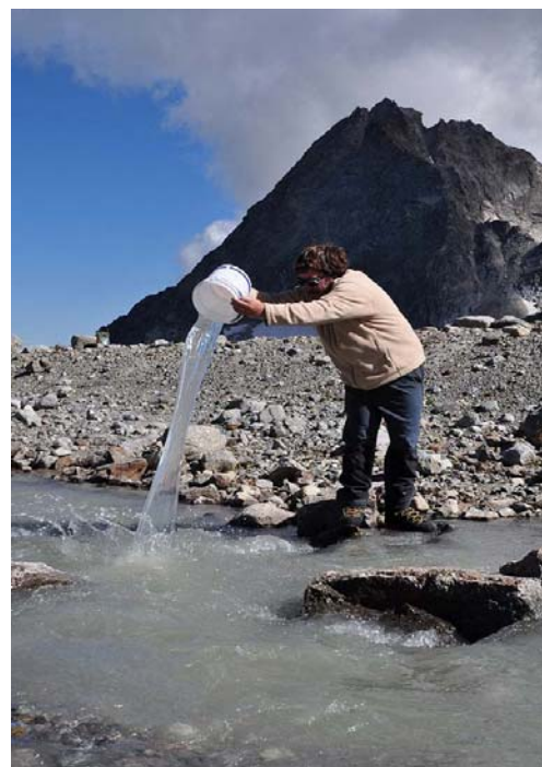
Il torrente glaciale è alimentato dalla moderata fusione in un pomeriggio segnato da temperature di circa 7 °C alla fronte del ghiacciaio (2850 m). Le prime misure di portata, calibrate tramite diluizione di una soluzione salina a concentrazione nota in prossimità dello stramazzo scelto per i rilievi (destra) ha fornito un valore di circa 200 l/s.
