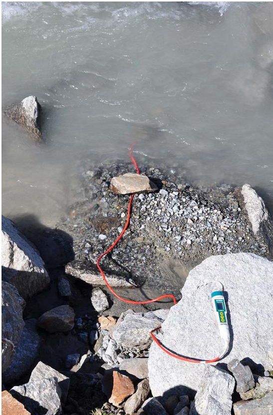
Misure di conducibilità elettrica delle acque del torrente glaciale per la taratura delle misure di portata.
