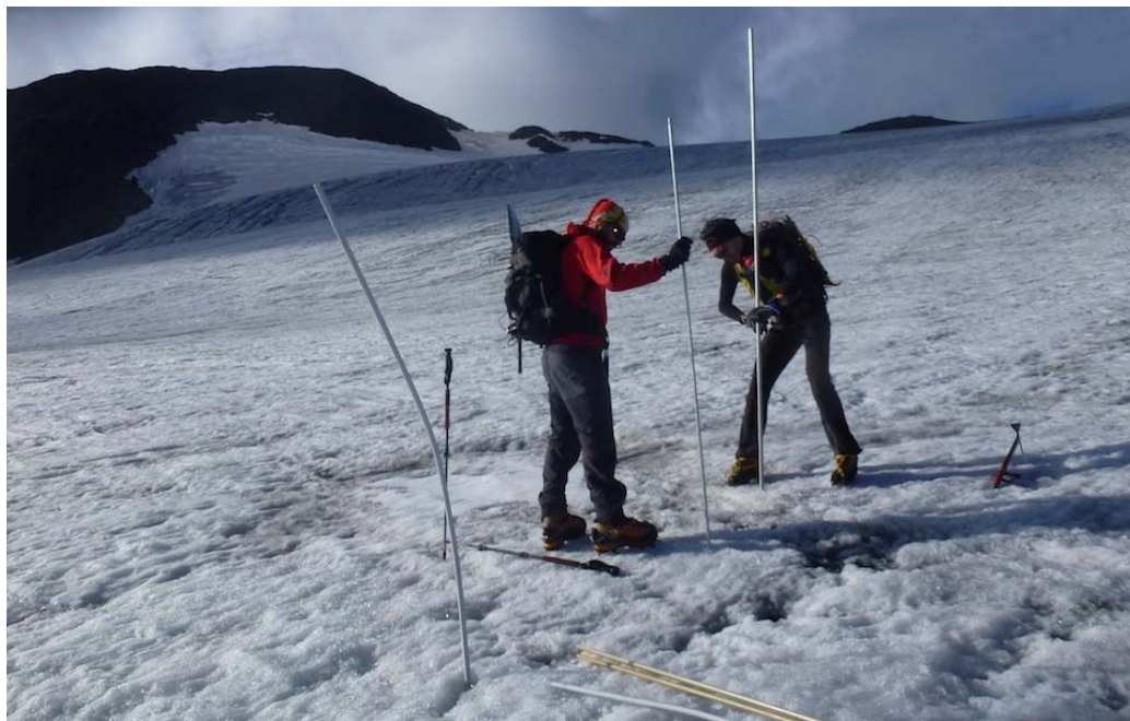
Fig. 3. Posa di una palina ablatometrica di 3 m con la rispettiva trivella. La vecchia palina, leggermente storta, è immersa e bloccata per circa un metro nel ghiaccio, per cui ne viene installata una seconda. L'estate prossima indicheranno la perdita di spessore del ghiacciaio.
