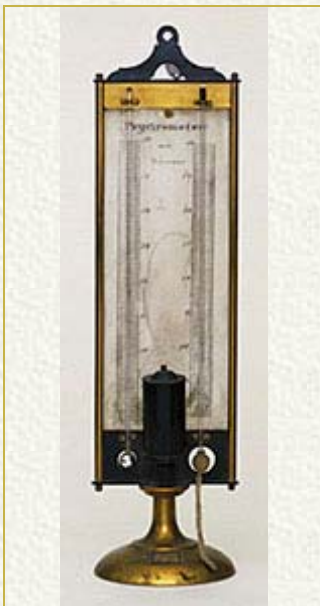
Figura 3 - Psicrometro Seconda metà XIX sec Fonte: IMSS
