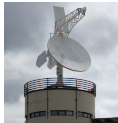
1b. Radar meteorologico di ricerca POLAR 55C: è un radar Doppler in banda C a doppia polarizzazione installato presso CNR-ISAC, Roma Tor Vergata (cortesia L. Baldini, CNR-ISAC).
