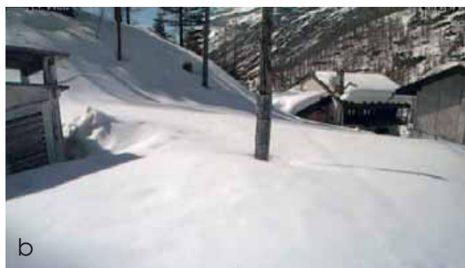
2. Modalità tradizionali e moderne di misura dello spessore nevoso al suolo. (a) Asta nivometrica per la lettura diretta - di solito ogni mattina - dell'altezza neve (Rifugio Fontana Mura, 1726 m, Val Sangone - TO); pressoché tutte le lunghe serie di dati alpini sono costituite da dati osservati in questo modo. (b) Asta nivometrica storica oggi teleosservata tramite webcam per ovviare al cesato presidio sul posto. Adattamento tecnologico che permette (rebbe) di salvare dalla chiusura importanti stazioni di montagna, come avvenuto qui, a Gressoney-D'Ejola (1850 m, M. Rosa, serie utilizzata in questo studio) grazie a una collaborazione tra SMI e Centro Funzionale della Regione Autonoma Valle d'Aosta. (c) Stazione meteorologica automatica ARPA Piemonte con nivometro (Ceresole Reale, 1581 m, Gran Paradiso): l'altezza neve viene dedotta dal tempo di ritorno di ultrasuoni emessi dal sensore e riflessi dalla superficie del manto (tempo più breve = distanza minore = neve più spessa, e viceversa). Apparecchi molto diffusi dagli Anni Novanta, permettono il monitoraggio continuo in zone remote, ma richiedono un'attenta validazione dei dati per rimuovere il rumore di misura (segnali indesiderati) e valori spuri (presenza di erba sotto al sensore, difficilmente distinguibile dal segnale generato da piccole nevicate soprattutto tra la tarda primavera e l'autunno).
