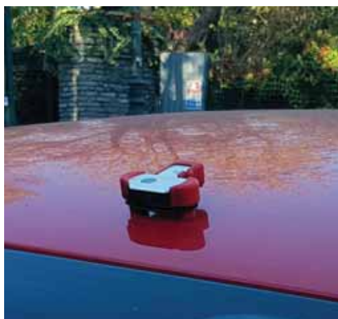
1-2. Dettaglio del MeteoTracker ed esempio della sua collocazione sul tettuccio di un'automobile. Gli appositi algoritmi di correzione del software permettono una misura ragionevolmente affidabile di temperatura e umidità relativa anche con lo strumento esposto alla radiazione solare, purché il veicolo sia in movimento con velocità da circa 10 km/h in su (f. G. Antoniciello).
