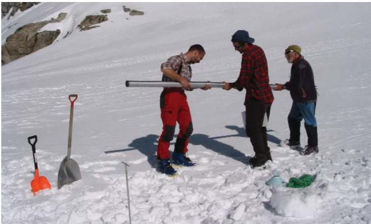
Sopra, misure di spessore e densità del manto nevoso a fine primavera sul ghiacciaio Ciardoney, tramite il prelievo e la pesatura di campioni di neve con tubo carotiere (maggio 2002). Misure SMHRIDE Energia.
